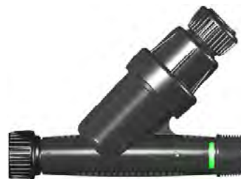
Filtro a Y con Riduttore di Pressione Ghiera Libera 3/4" (in ingresso) Filetto Maschio 3/4" (in uscita) 2,5 bar (Verde)
